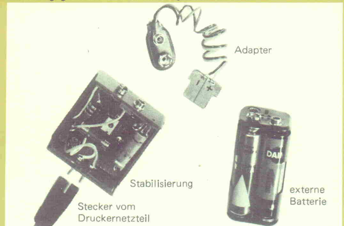
Bild 1. Oben sieht man den selbstgestellten Stecker mit Batterieclip, unten links die Stabilisierung nach Bild 2, unten rechts die Versorgung mit externen Batterien.
